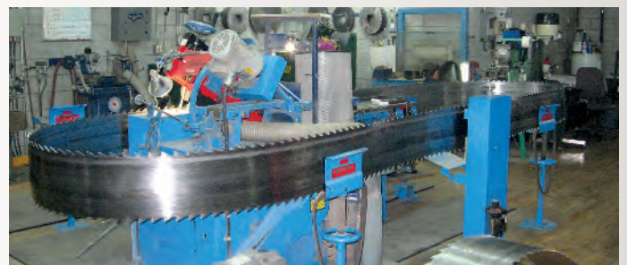
Scierie Carrière améliore constamment ses équipements comme en fait foi cette nouvelle station d'affûtage dont on terminait l'installation lors de notre visite.
