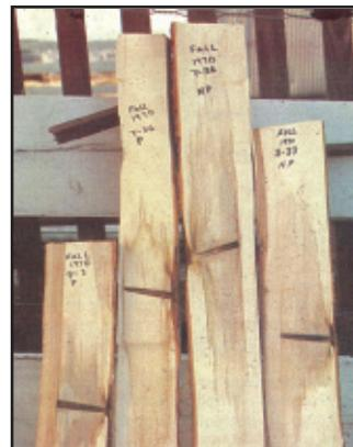
Figure 1. Vue en coupe radiale. Coloration du bois « mort » au-dessus et au-dessous de l'entaille.
